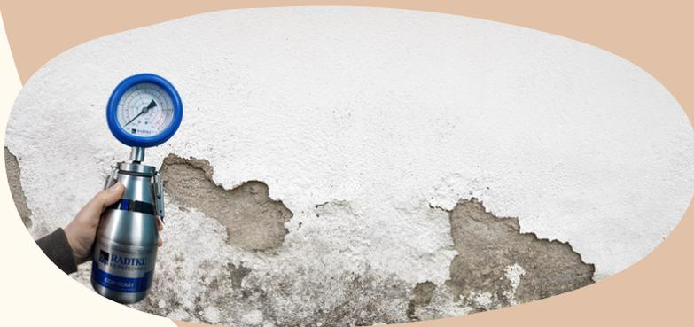
Queste prove possono essere richieste per valutare lo stato pre posizionamento di Geniè, per valutare la situazione iniziale ma anche dopo il posizionamento per valutare l'asciugatura del muro e quindi valutare l'eventuale passo successivo di risanamento murario e quindi capire che intonaco utilizzare.
