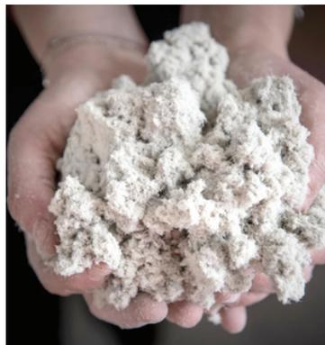
L'insufflaggio termico è la tecnica ideale per la riqualificazione energetica degli edifici esistenti. La tecnica consiste nel soffiare materiale isolante di vario tipo nelle intercapedini o negli spazi vuoti dei solai o tra le travi dei sottotetti.
